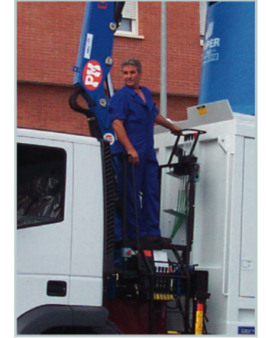
Raised control station: maximum angle of visibility Puesto de maniobra en pie: máximo ángulo de visibilidad.
